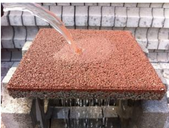
硬质透水铺装
