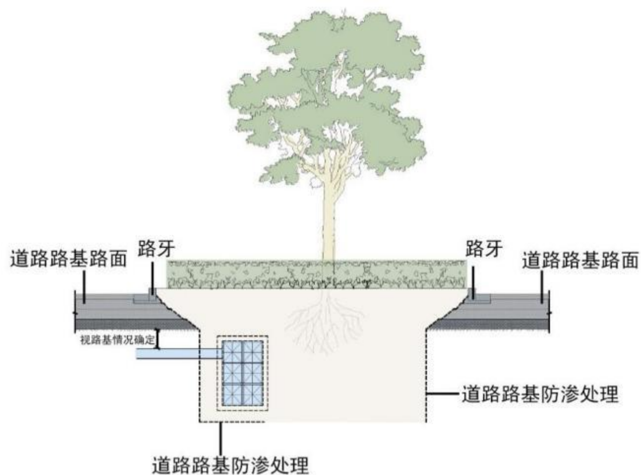
绿化与道路结构工程的协同示意（非下凹式）
