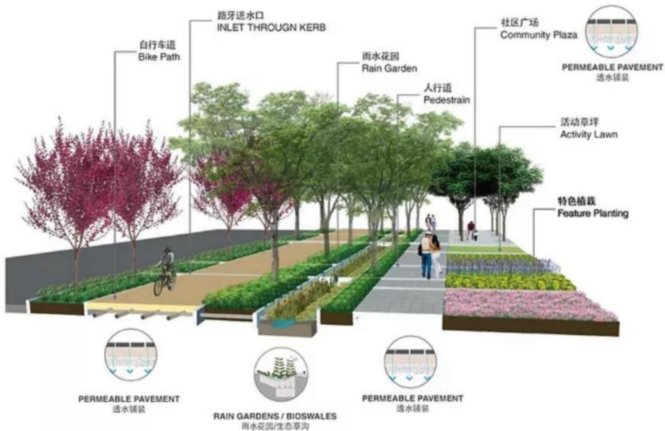
道路海绵设施示意简图
